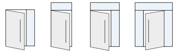
Porte 1 vantail et fixe    Porte 1 vantail et imposte    Porte avec fixe et imposte    Porte avec 2 fixes et imposte
