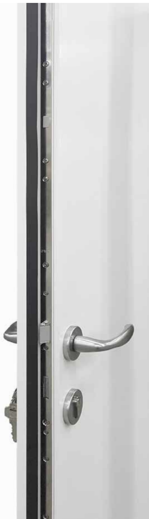
Serrure À RELEVAGE 6 points de verrouillage 4 rouleaux 1 pêne 1 pêne 1/2 tour Serrure automatique en option pour les portes d'entrée 50.
